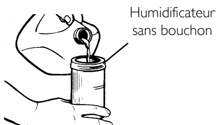
FIGURE 6.1 Remplissage de l'humidificateur
