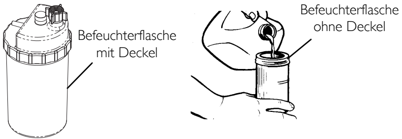
ABBILDUNG 6.1 Auffüllen des Befeuchters
