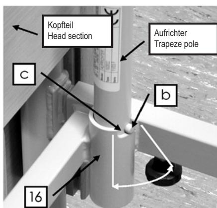
In den beiden Ecken des Liegeflächenrahmens, an der Kopfseite, befinden sich zwei runde Aufrichterhülsen [16]. Die Aufrichterhülse hat an der Oberseite eine Aussparung [c], die zusammen mit dem Stift [b] den Schwenkbereich des Aufrichters begrenzt. Der Aufrichter sollte auf der Seite des Bettes angebracht werden, wo der Patient ein- und aussteigt.
